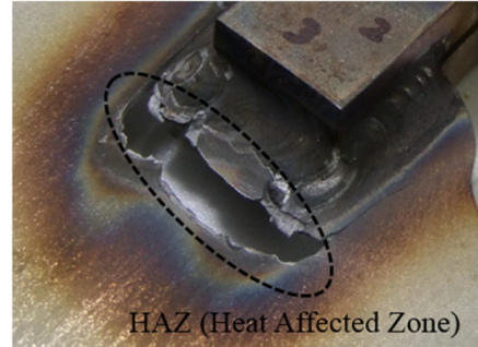
(d) SALT20L0 : Tensile fracture and shear fracture section
